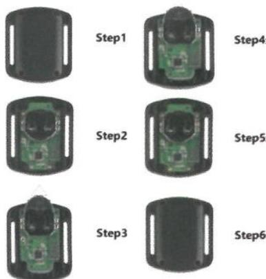
**Passaggio 1:** Utilizzare un cacciavite con punta da 1,84 mm (non incluso) per rimuovere le 4 viti dal coperchio posteriore, consentendo di aprire il coperchio posteriore.
